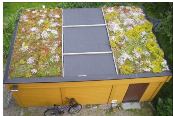
Figur 7. Ett år etter montering av filt over drenelementet (fig. 2), er GT1b (venstre) i ferd med å utvikle seg som sin nabo GT2.
