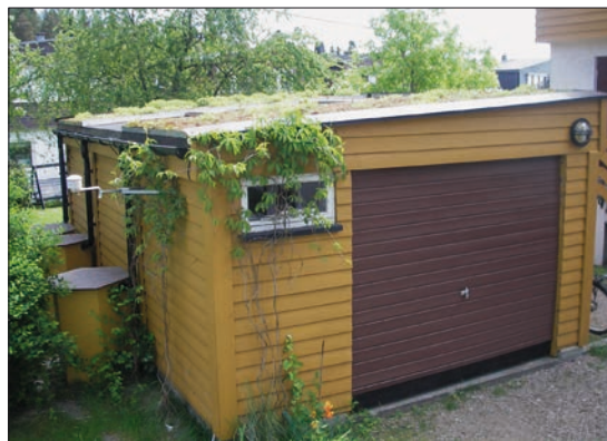
Figur 1. Forsøksfeltet L34b er en garasje der vann ledes fra 3 takflater til isolerte vandunker.
